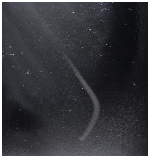
写真3 自作簡易霧箱が捉えた放射線
